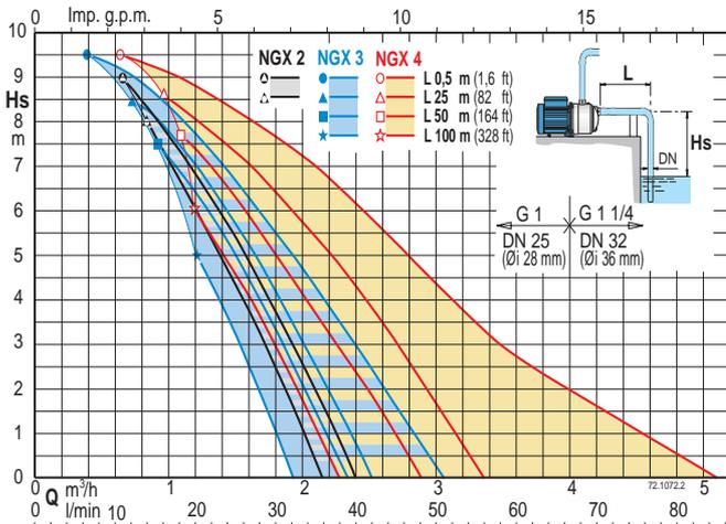
H: высота напора является суммой высоты всасывания, высоты подачи и потерь давления во всасывающей и подающей трубах.
