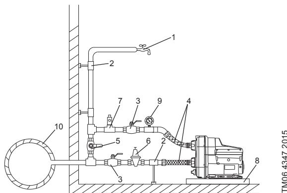
**Рис. 37.** Повышение давления воды из магистрального трубопровода
