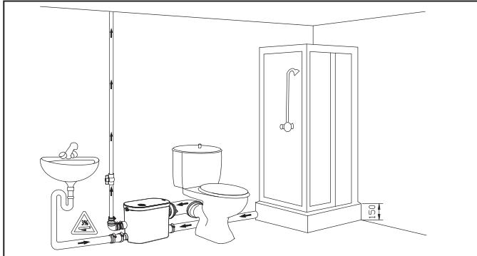
Туалетный насос JEMIX STP-250 предназначен для откачки сточных вод из раковин и душевых кабин до канализационной системы с возможностью подъема стоков.
